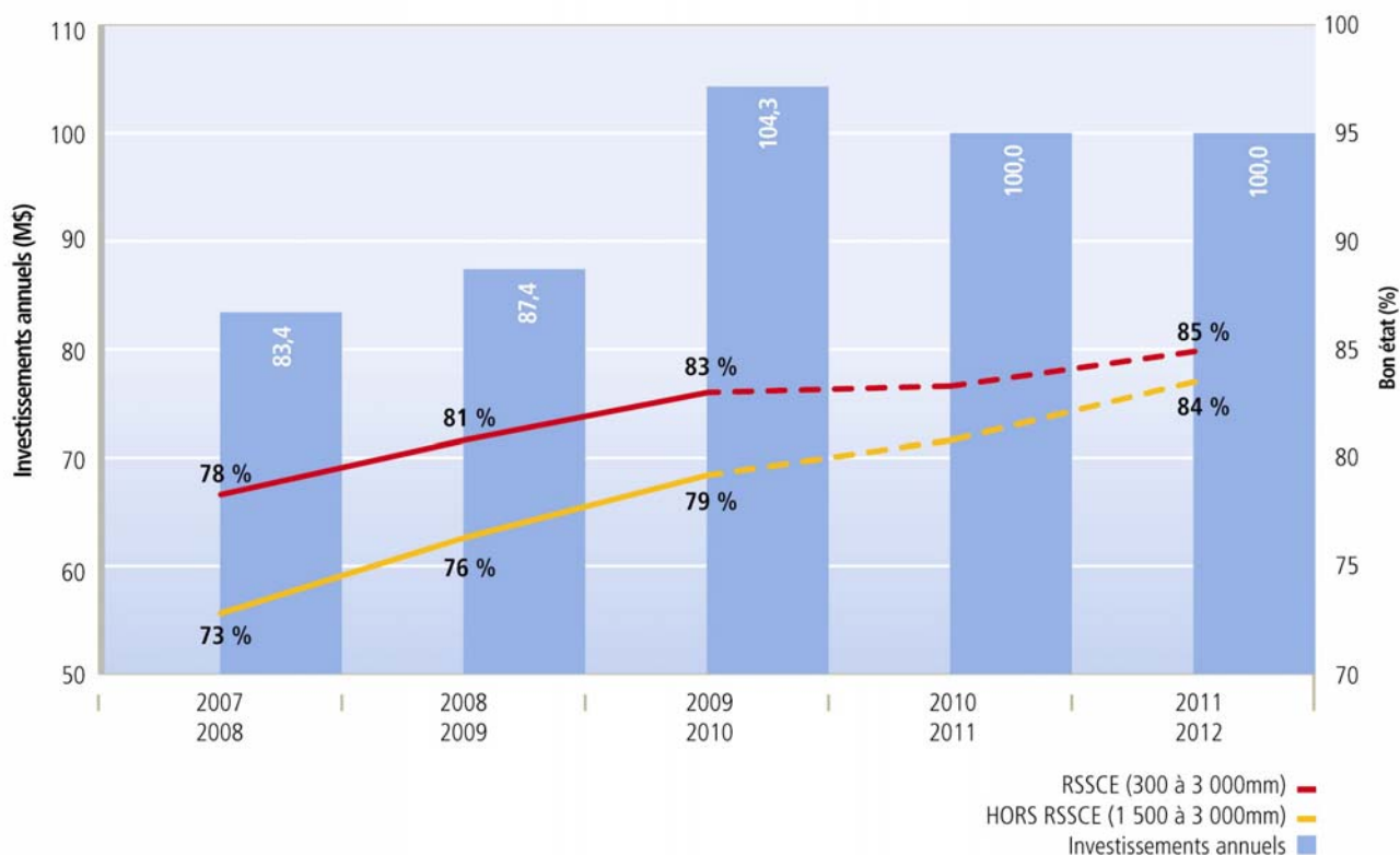
Figure 5 – Évolution de l'état des ponceaux et investissements annuels
