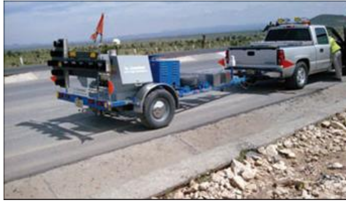
Figure 4 - Mesure des déflexions des chaussées avec un équipement HWD dans une route fédérale sans frais (Osio, 2010).
