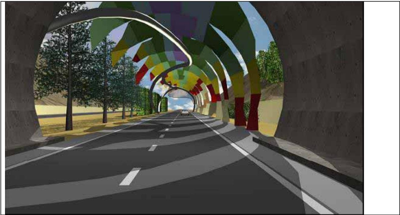
Figure 7. Évaluation de l'éblouissement solaire sur un tunnel routier en Espagne.<sup>46</sup>
