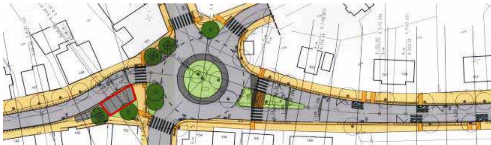
Exemple d'obstruction de visibilité aux passages pour piétons causée par des véhicules stationnés
