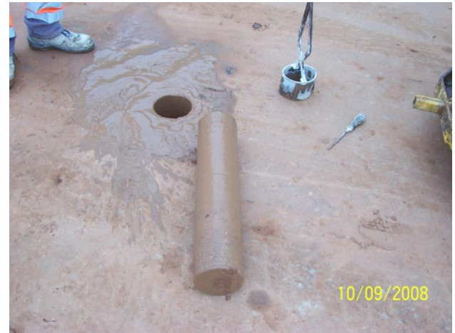
Carottage - Sables homométriques
