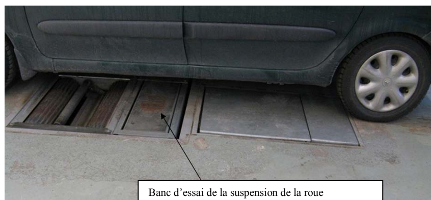
Figure 4. Banc d'essai avec rouleaux à vibration utilisé pour étudier l'effet de la pression du pneu.
