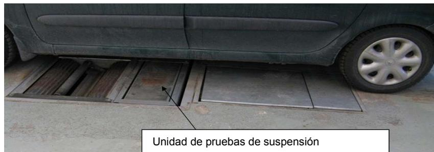
Imagen 4. Para estudiar el efecto de la presión de los neumáticos se utilizó el equipo con placas de vibración
