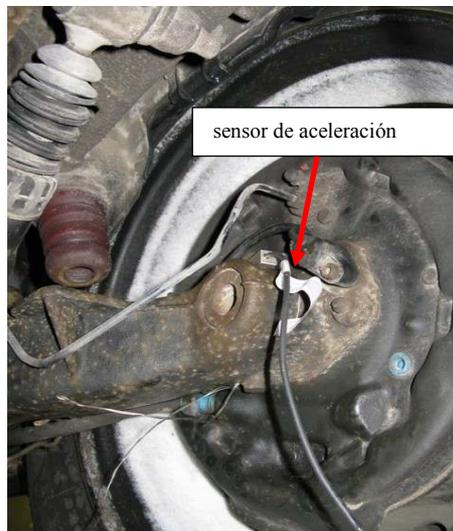
Imagen 2. El lugar de la suspensión de la rueda donde se monta el detector de aceleración.
