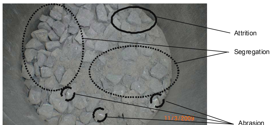
Figure 5 – Exemple de phénomènes d'attrition, de ségrégation et d'abrasion observés à 100 girations en utilisant la presse à cisaillement giratoire (PCG).
