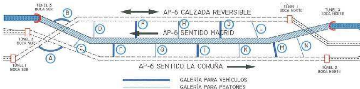
“Figura 5 – Esquema de túneles y galerías”
