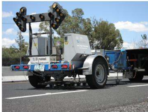
Figure 2 – Des mesures de déflexions sur le réseau routier fédéral.
