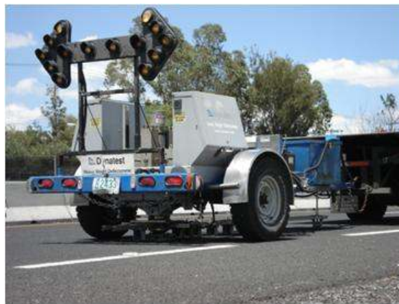
Figura 2 - Medición de deflexiones con deflectómetro de impacto en la red federal.
