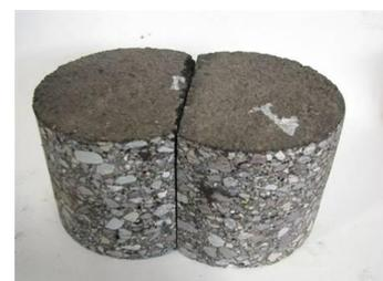
Avec le bitume 35/50 l'essai n'arrive pas à son terme. Ceci est du à un phénomène de Striping manifeste. Avec le bitume 10/20 l'essai arrive à son terme avec des résultats remarquables. C'est la confirmation des résultats trouvés en comparant les liants 50/70 et 20/30. Avec les liants 10/20 et 20/30 le phénomène de stripping disparaît. Ceci est du au process particulier que nous utilisons (non évoqué dans cette étude). La variation du % du liant 10/20 n'influe pas sur les résultats d'ornièrage.
