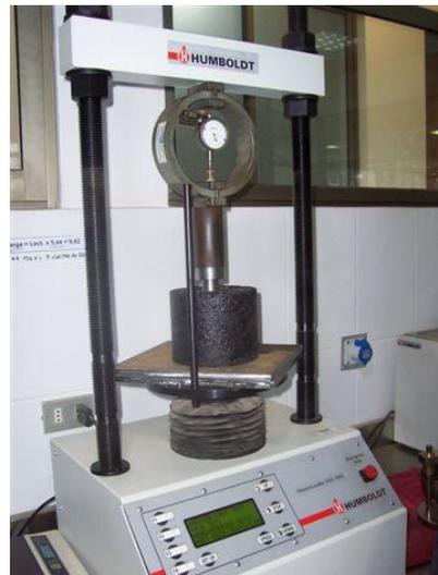
En fonction du diamètre et de la hauteur de l'éprouvette mesurée et la diffusion de charge se faisant à 45°, la rupture de l'éprouvette peut être affecté car celle-ci n'est pas confinée. La comparaison en fonction du type d'éprouvette et de piston est donc nécessaire.
