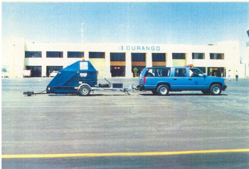
Figura 5 - Mediciones de deflexión con equipo FWD. Aeropuerto de Durango. Pavimento con "Sección Invertida"
