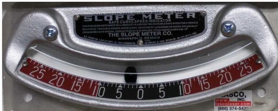
Figura 3 - Indicador de velocidad segura en curvas
