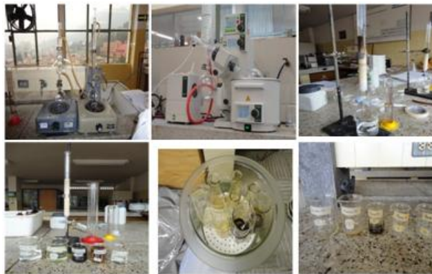
Figura 3 Separación del asfalto en sus cuatro fracciones SARA (Saturados, Aromático, Resinas, Asfáltenos)
