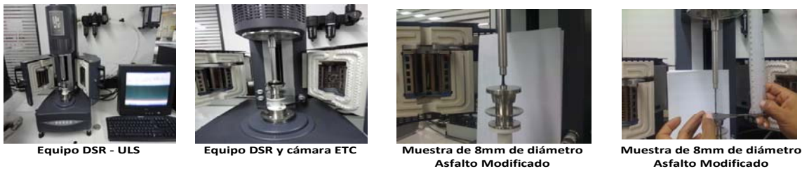
Figura 9 Reómetro de Corte Directo DSR
