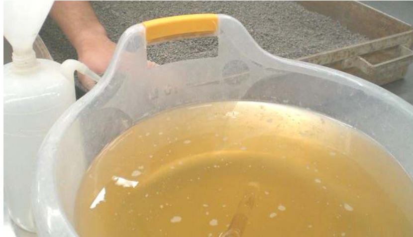
Figure 3 – Apparence de l'eau de compactage ajoutée d'un agent de stabilisation liquide (polymère).
