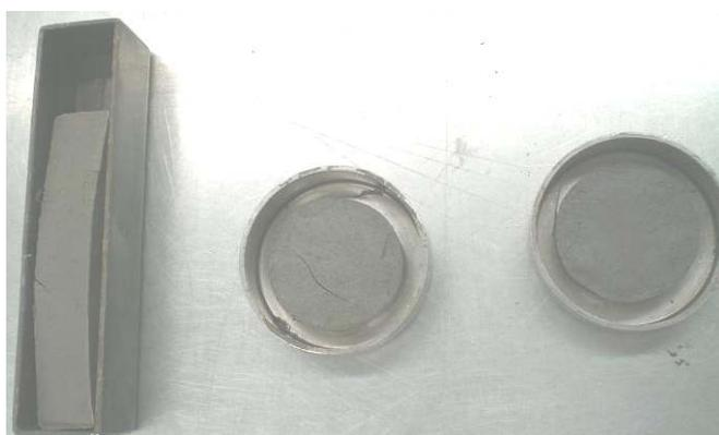
Figura 4 – Contracción del suelo utilizado en la estabilización con cal y polímero
