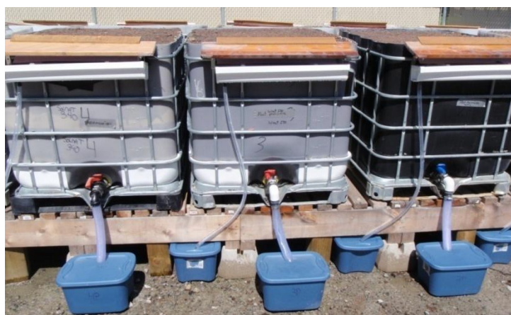
Figure 3 – Système de récupération de l'eau de percolation et de ruissellement à l'Université Laval
