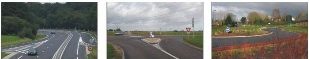
Figure 3 – Photographies d'aménagements évalués. Giratoire à terre-plein central franchissable, « 2+1 », carrefour « cacahuète ».
