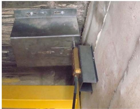
*Figura 5- Extensómetro óptico instalado en apoyos*
