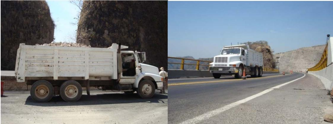
*Figura 8-Camión utilizado en la prueba de carga y su paso por la estructura*
