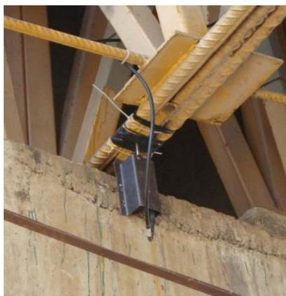
*Figura 3-Detalle de la instalación de un extensómetro óptico en los apoyos*
