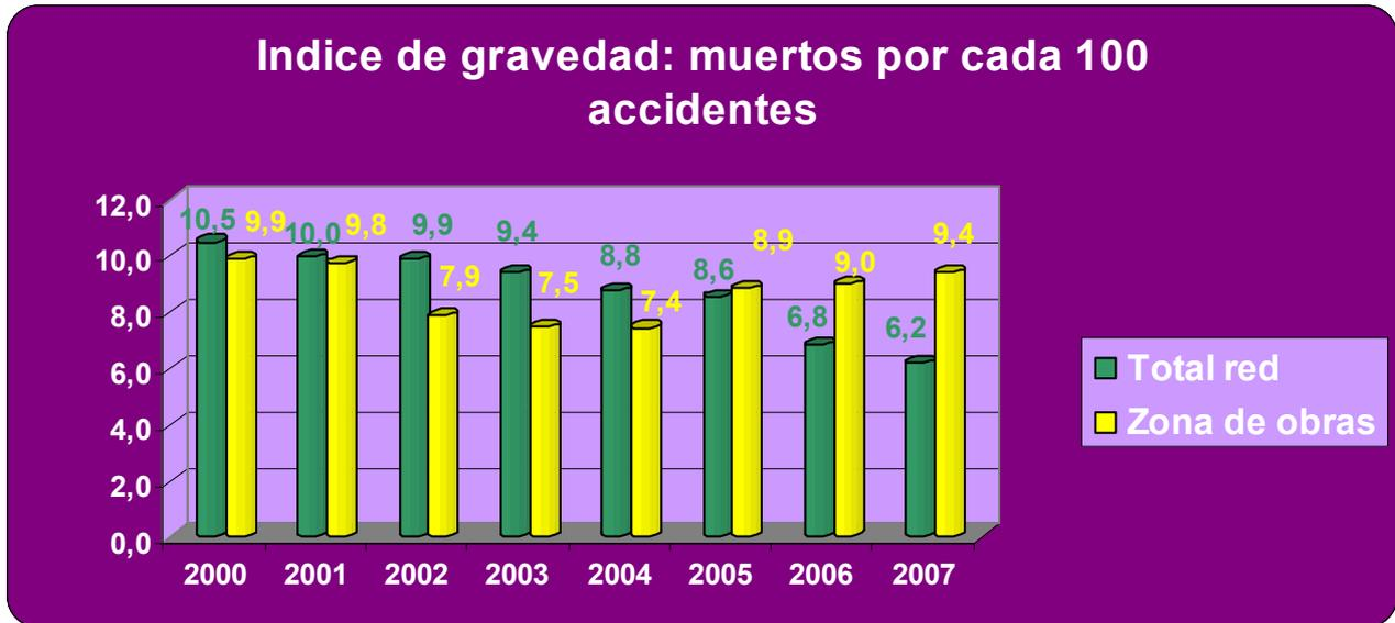
Figura 4 - Comparativa de evolución del Índice de Gravedad en el conjunto de la red y en las zonas de obras
