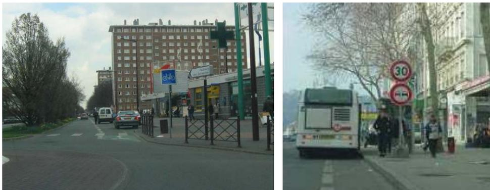
Figure 4 – Bande cyclable envahie par le stationnement à gauche – par un bus à un arrêt à droite
