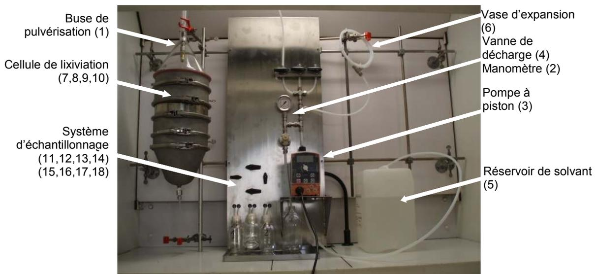
Figure 2 - Photographie du dispositif expérimental d'extraction par lixiviation
