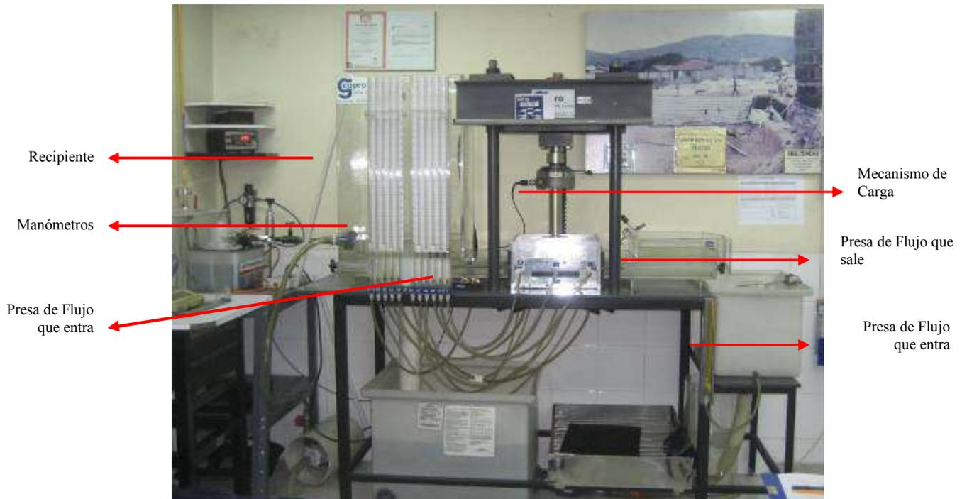
Fotografía 4. Montaje del equipo de tasa de flujo y transmisividad
