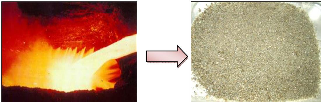
Figure 5 - Obtention du laitier granulé par le procédé de granulation
