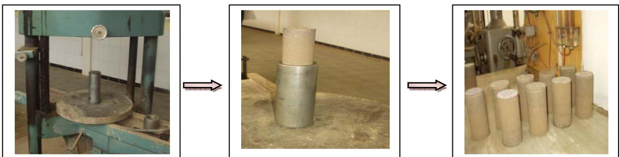
Figure 14 - Confection des éprouvettes par le compactage statique
