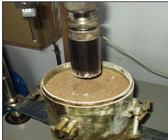
Figure 12 - Poinçonnement CBR d'une éprouvette de sable laitier
