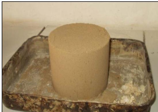
Figure 10 - Éprouvette de sable laitier compactée dans le moule CBR
