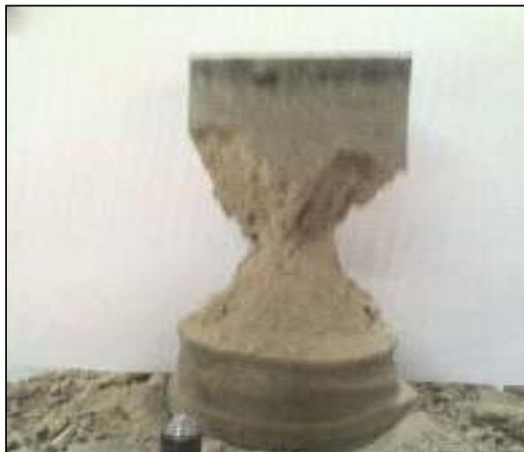
Figure 16 - Éprouvette de sable laitier écrasée à 90 jours
