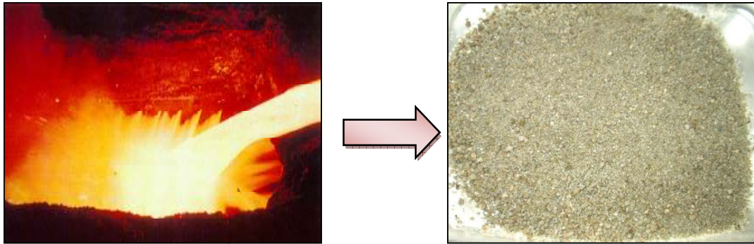
Figure 3 - Obtention du laitier granulé par le procédé de granulation
