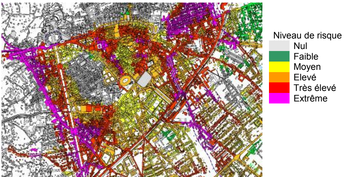
Figure 10 - Exemple de scénario de crue (risques + vulnérabilités) utilisé avec le système ESPADA pour la ville de Nîmes
