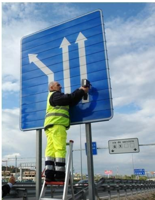
Figura 1. Medida con retroreflectómetro puntual.
