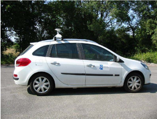
Figure 2 - Le système MRT embarqué dans le véhicule d'essai VERT de l'IFSTTAR
