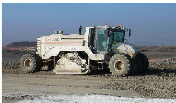
Figura 6. - Maquinaria de mezcla del material con la cal
