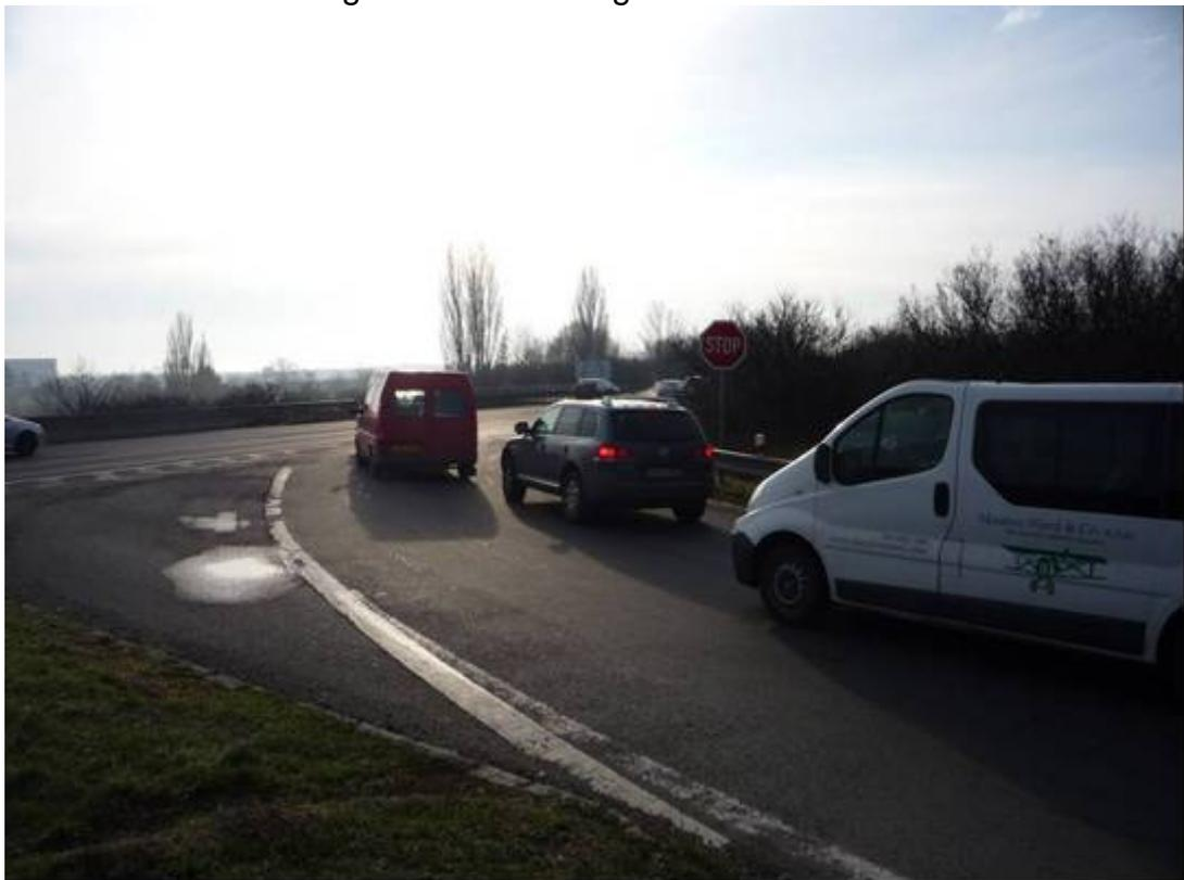
Figure 13 : Échangeur autoroutier sans voie d'accélération
