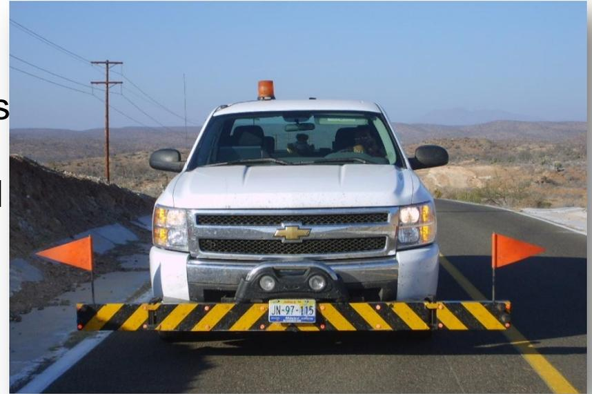
La medición se efectúa en el carril derecho y en el sentido del cadenamiento para carreteras de dos carriles; para el caso de cuatro ó más carriles se lleva a cabo en el de baja velocidad de cada sentido.
