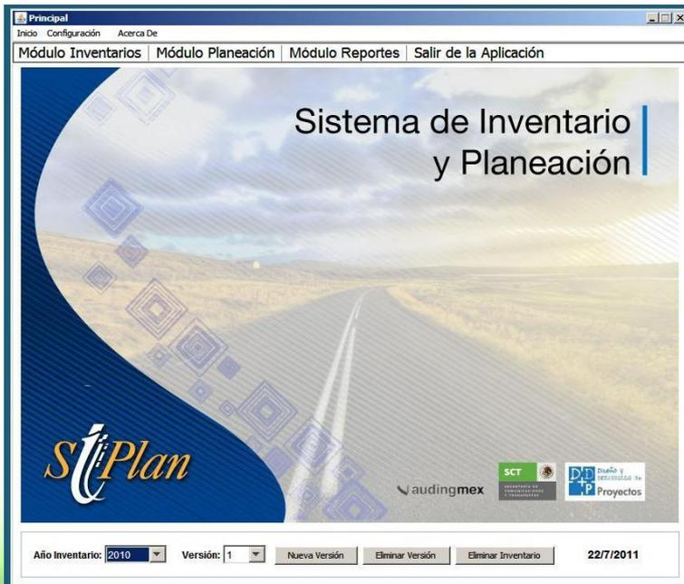
El SIPLAN relaciona los diferentes tipos de defectos del inventario de daños con los parámetros de condición requeridos por el HDM-4.
